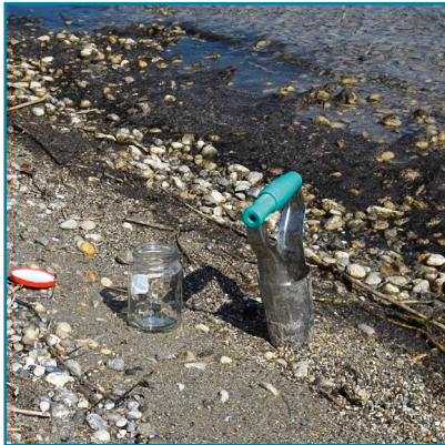
Mit einem Blumenzwiebelsetzer wird eine Probe aus dem Spülsaum des Gewässers gemacht (Tiefe ca. 5 cm).
