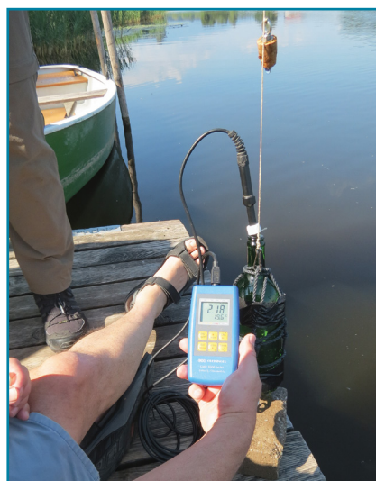
Mit der Sauerstoff-Elektrode wird der Sauerstoff-Gehalt gemessen.
